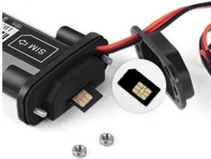
Abb. 6 SIM Karte einlegen
