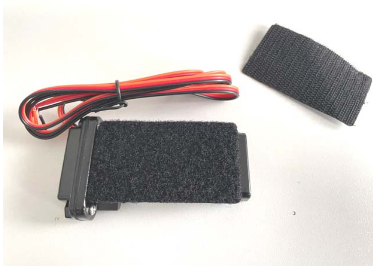
Abb. 13 Klettelement auf Gerät aufkleben
