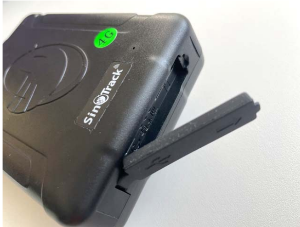
Abb. 2 GPS Ortungsgerät ST915 mit geöffneter Staubschutzklappe
